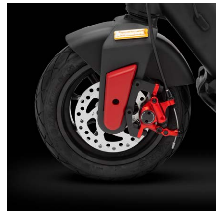
Freno a disco anteriore e posteriore
